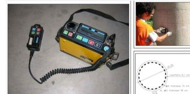
**SONREB.** Indagine, non distruttiva, eseguita sul calcestruzzo indurito, per determinare la resistenza (Rc) del calcestruzzo in opera, correlandola alla velocità ultrasonica (V), ottenuta con prove ultrasoniche e con l'indice di rimbalzo (S), ottenuto con prove sclerometriche.
