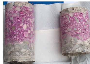
**CARBONTEST.** Verifica sul livello di carbonatazione dei ferri, consiste nel raccogliere con continuità le polveri prodotte durante la perforazione di un manufatto in calcestruzzo, effettuata con trapano a percussione con punte per muratura di 10 mm. Il campione di polvere ottenuto si mette a contatto con la soluzione alcolica di fenoftaleina: il calcestruzzo carbonatato non modifica il suo colore, mentre quello non ancora raggiunto dalla carbonatazione assume il tipico colore rosso magenta.
