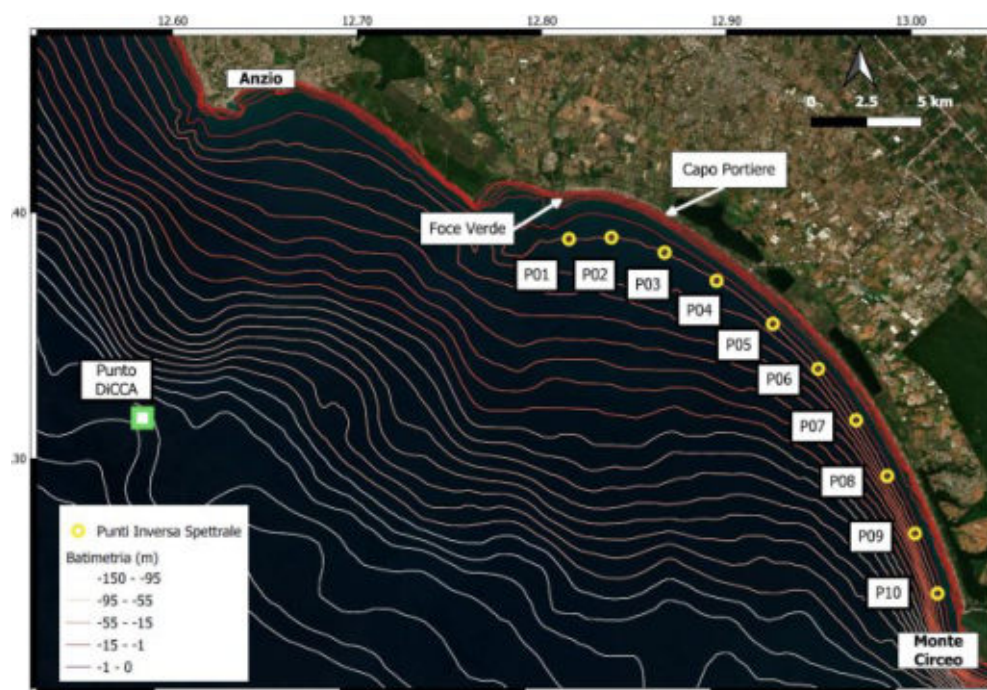
Figura 56 – Dominio di calcolo e indicazione dei punti di inversa spettrale.
